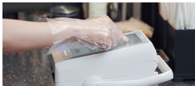
加圧式タッチパネルにより、手袋をつけたまま操作可能
