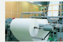
原紙生産工場 特殊ラベルも生産できる 原紙塗工製造設備
